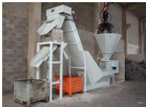
Système de broyage automatique avec séparateur magnétique
