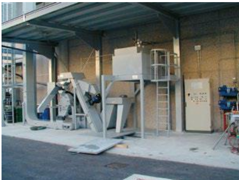
Détail de la zone d'évacuation des copeaux essorés
