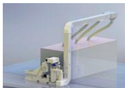
Minisystem avec convoyeur et 3 points de décharge
