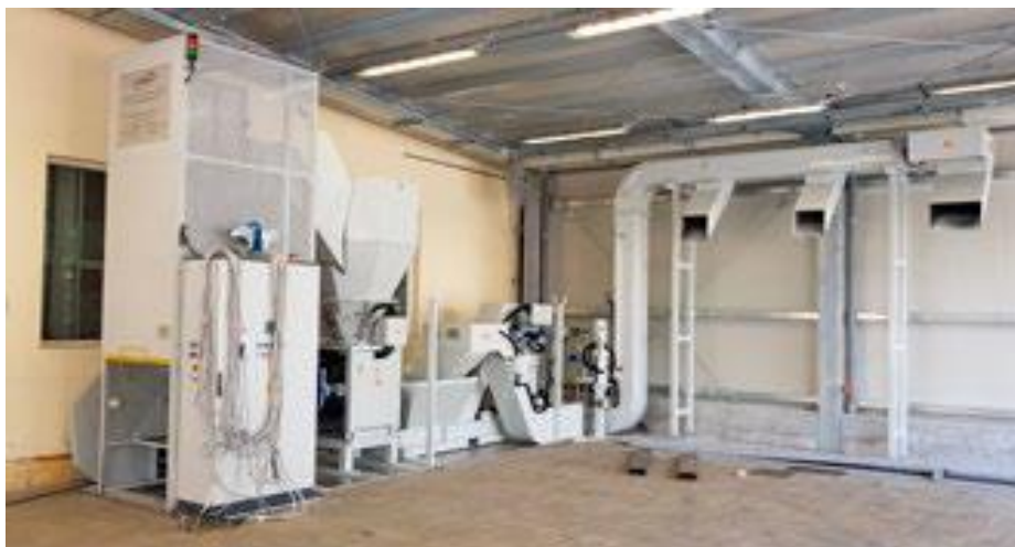
Minisystem avec élévateur de benne, broyeur, convoyeur et 3 points de décharge
