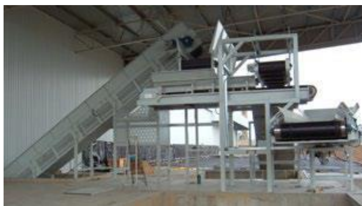
Ligne de transport de chutes d'aluminium et d'acier
