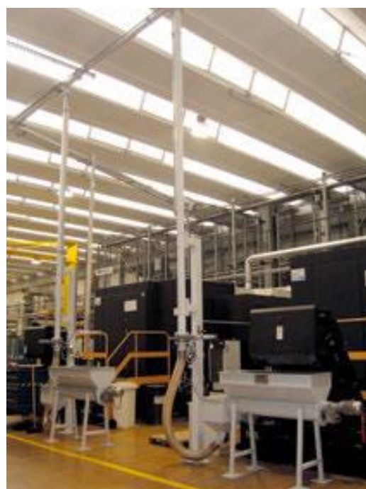
Station de vide pour copeaux fins d'aluminium
