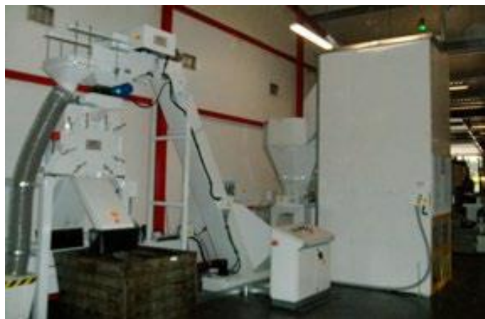
Système de broyage automatique avec essoreuse et élévateur videur
