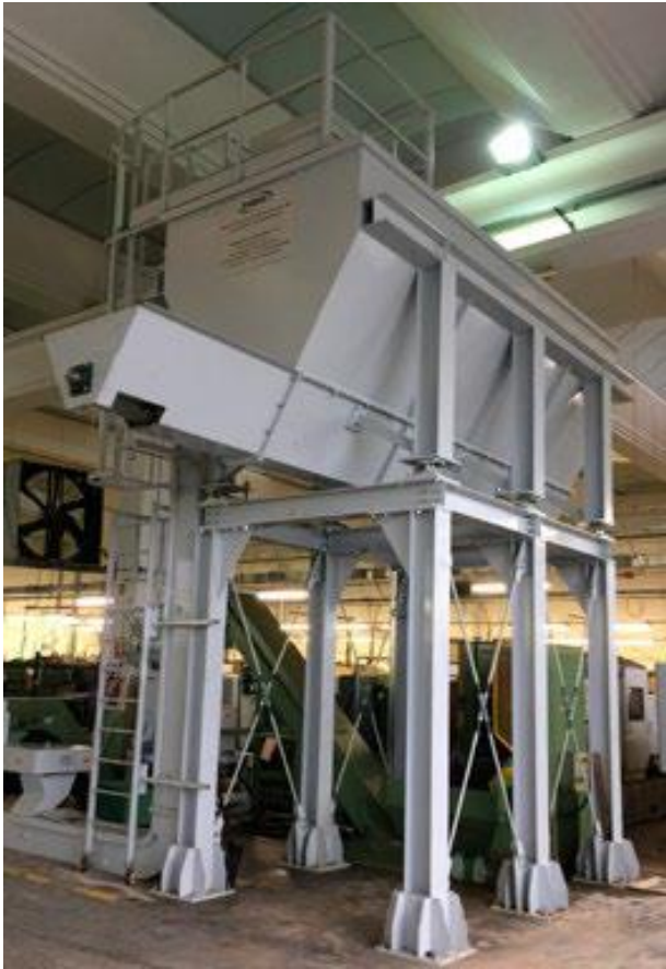
Silos horizontaux équipés de capteurs de pesage
