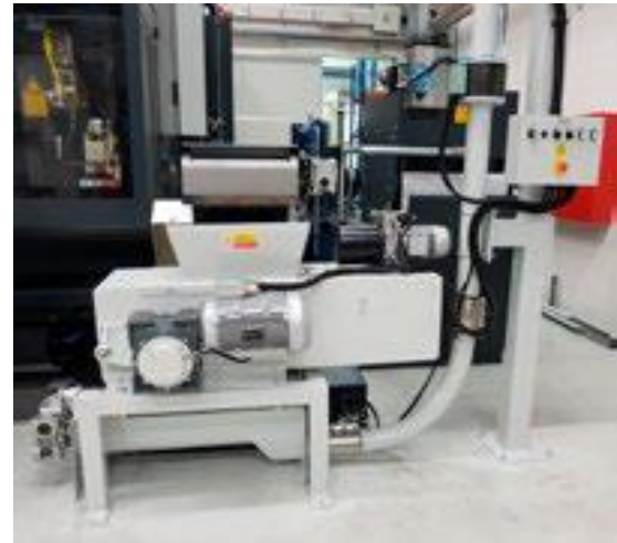
Station de vide équipée d'un broyeur
