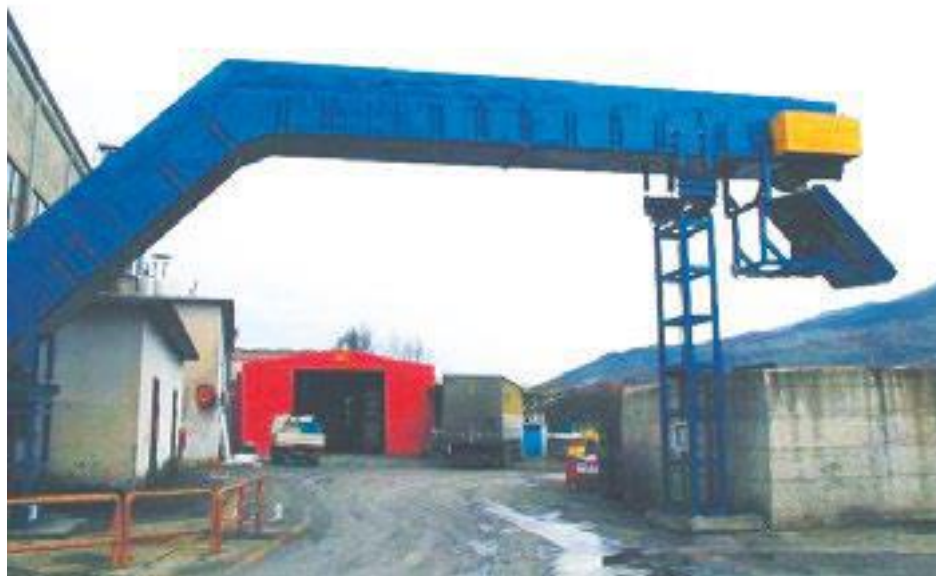
Convoyeur charges lourdes pour l'évacuation des déchets
