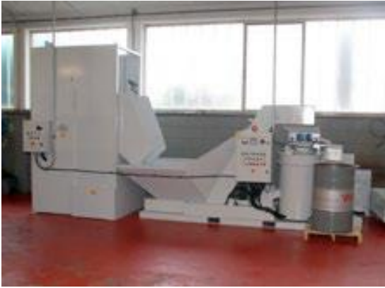
Minisystem avec élévateur de benne
