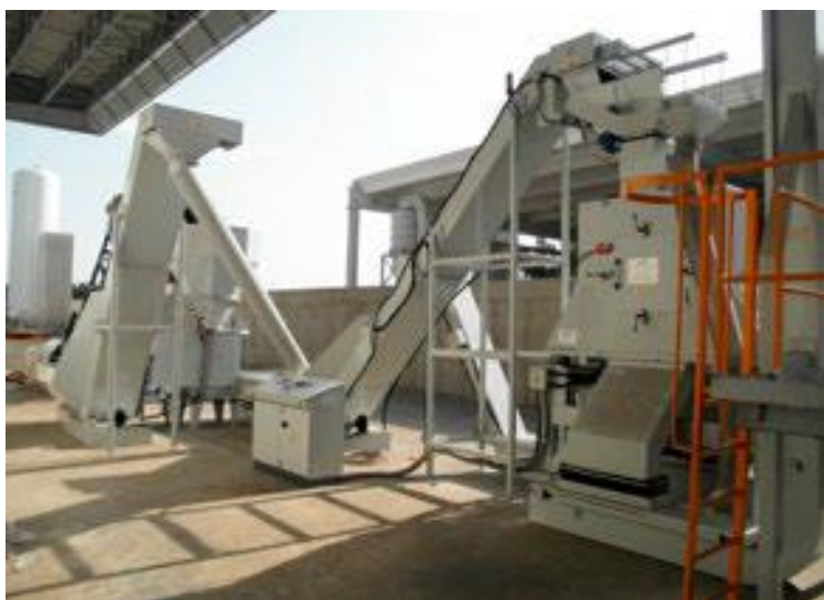
Système de broyage et d'essorage. Capacité : 3 tonnes / h pour les copeaux d'aluminium
