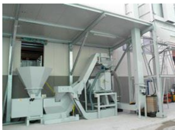
Broyeur, essoreuse et silos de stockage
