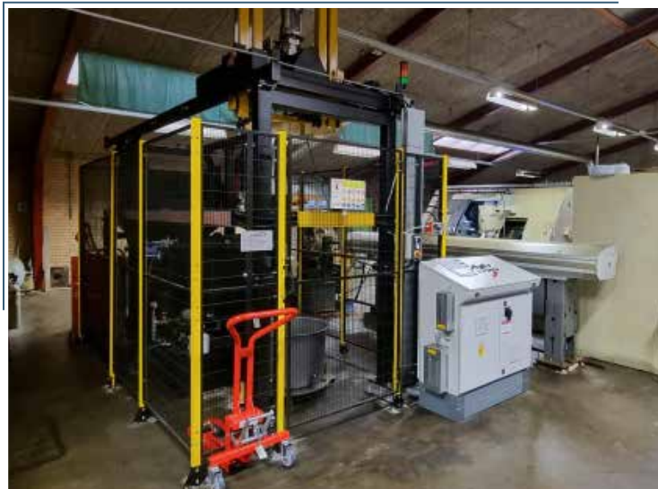
Système avec une station de déchargement pour plusieurs matériaux, avec entrée des paniers de manière latérale
