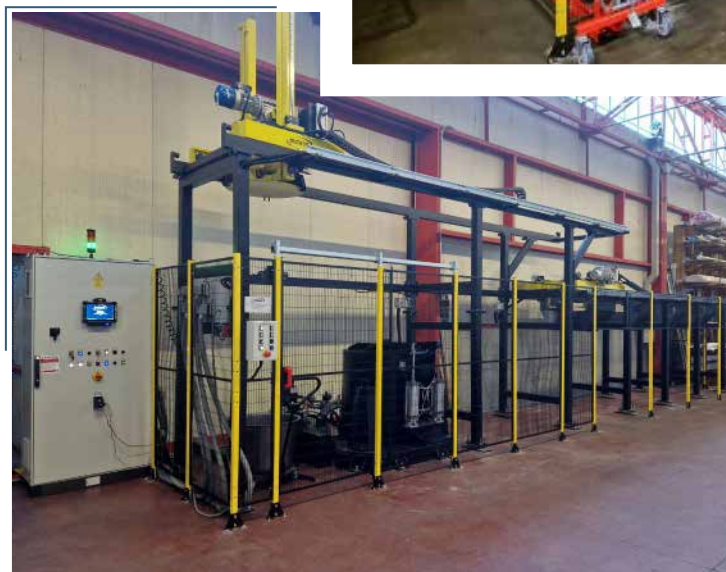
Système avec trois stations de déchargement
