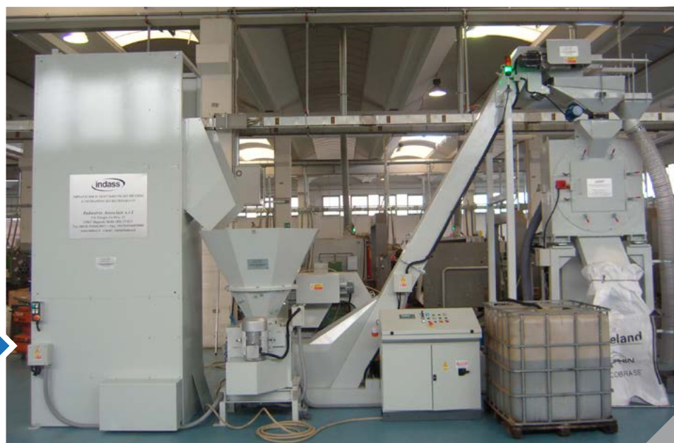
Impianto per l'elevazione automatica dei contenitori, tritrazione e centrifugazione trucioli.
