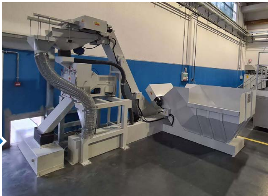
Impianto per la centrifugazione dei trucioli e insilaggio
