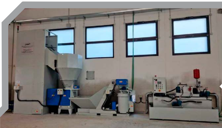
Impianto per l'elevazione automatica dei contenitori, triturazione e centrifugazione trucioli con unità centralizzata di filtrazione.
