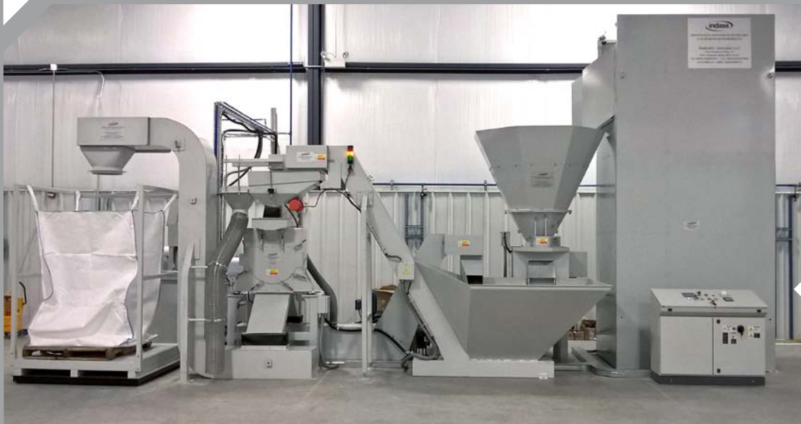
Impianto per l'elevazione automatica dei contenitori, tritrazione e centrifugazione trucioli con alimentazione al big bag.
