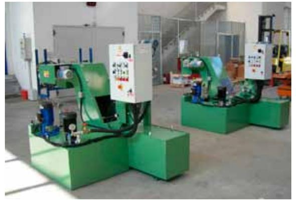
Transportador de rascadores con tambor filtrante rotativo y filtro autolimpiable. Nivel de filtración: 30 micras
