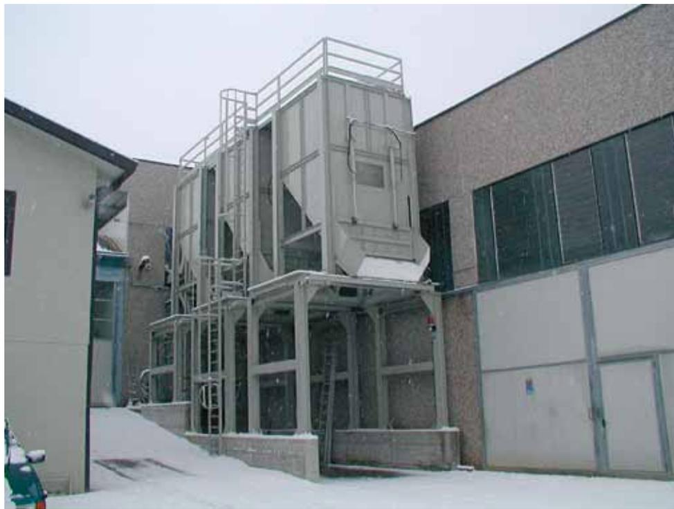
Conjunto de silos para el almacenamiento de virutas de acero y latón
