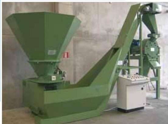
**Sistema de tratamiento de virutas constituido por una trituradora y una centrifugadora**
