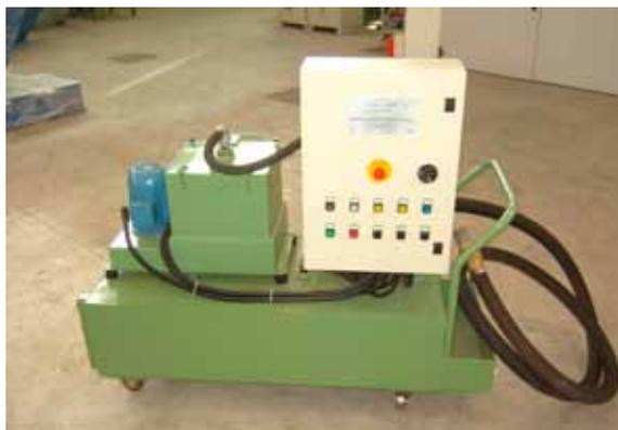
Centrifugadora para la filtración de aceite.
