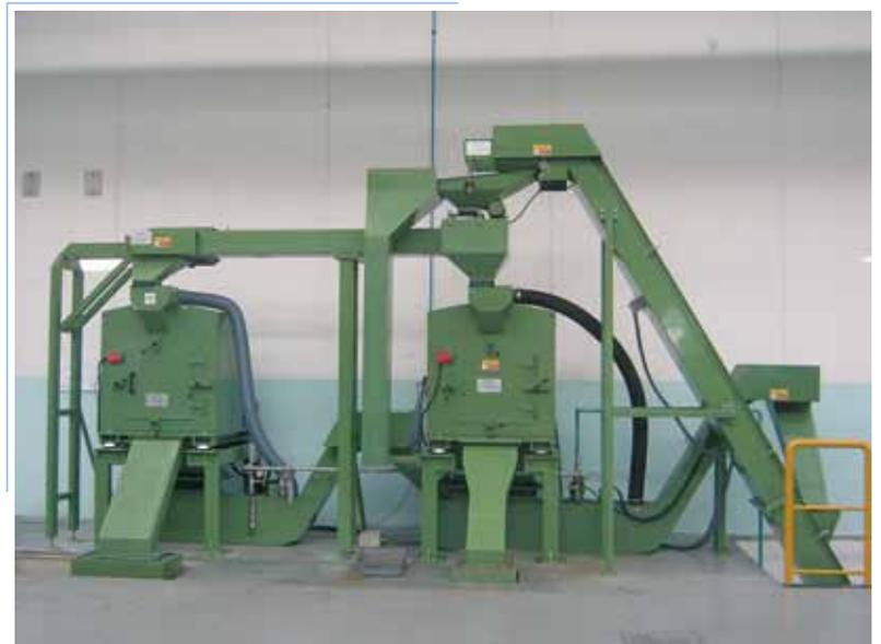
Sistema de centrifugado - Capacidad máx : 3000 kg/h
