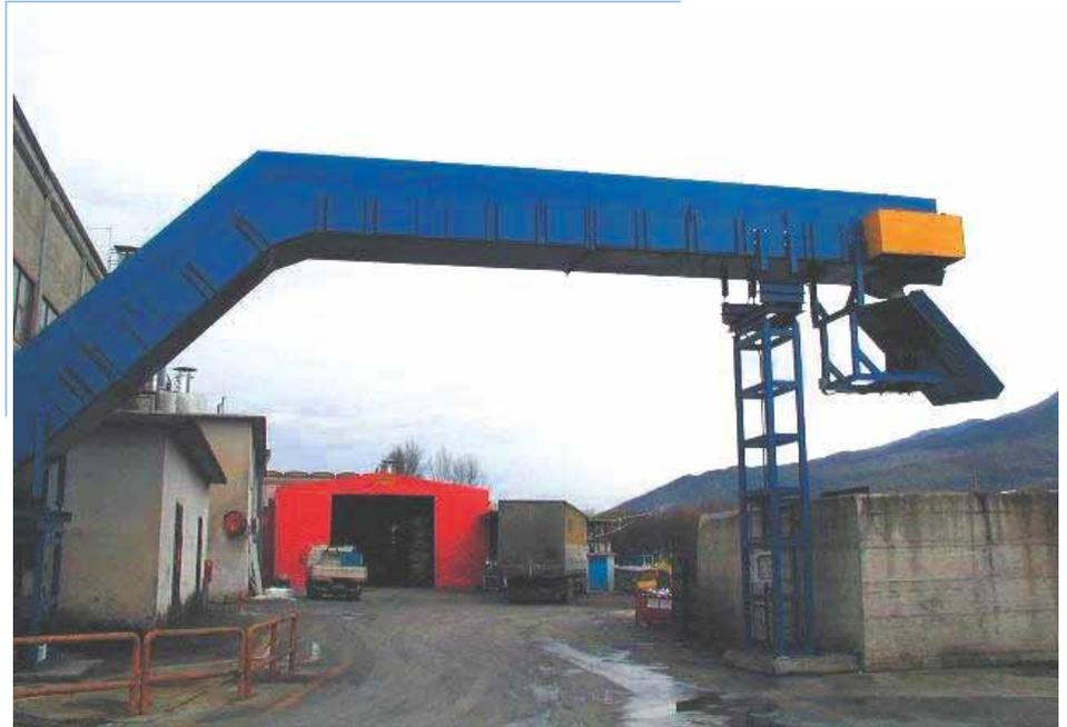
Cabeza de descarga de transportador para desechos, provista de boca de descarga pivotante
