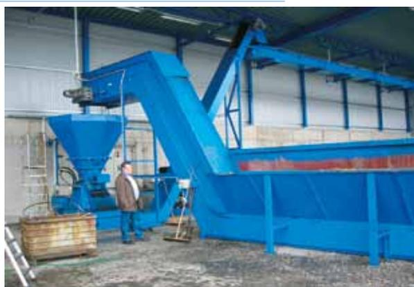
Sistema de triturado de virutas de aluminio transportadas por un transportador de rascadores
