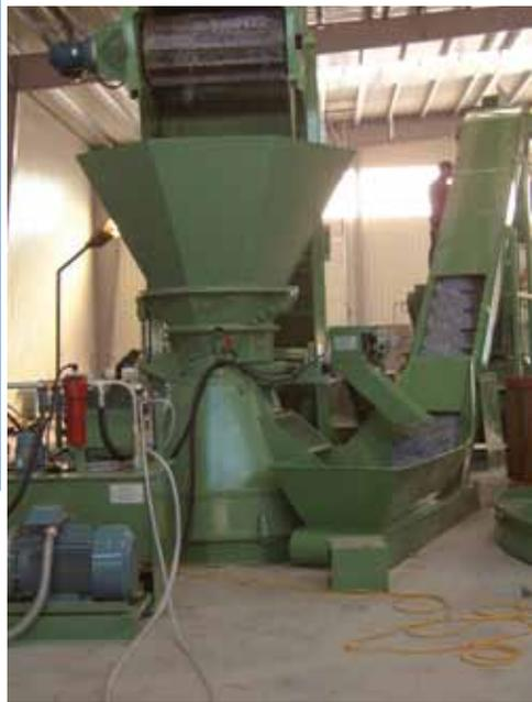
**Instalación de triturado y centrifugado de virutas previa a su nueva fusión**
