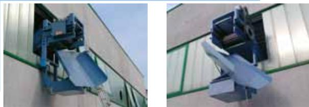
Boca de descarga pivotante (detalle)
