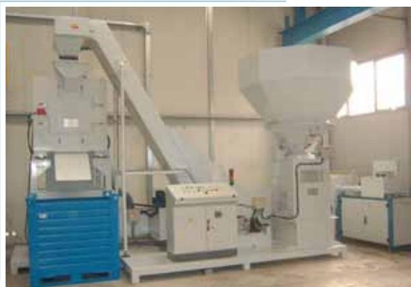
Sistema de tratamiento de virutas constituido por una trituradora y una centrifugadora
