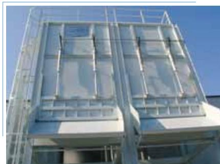
Detalle de las trampillas de descarga de las virutas
