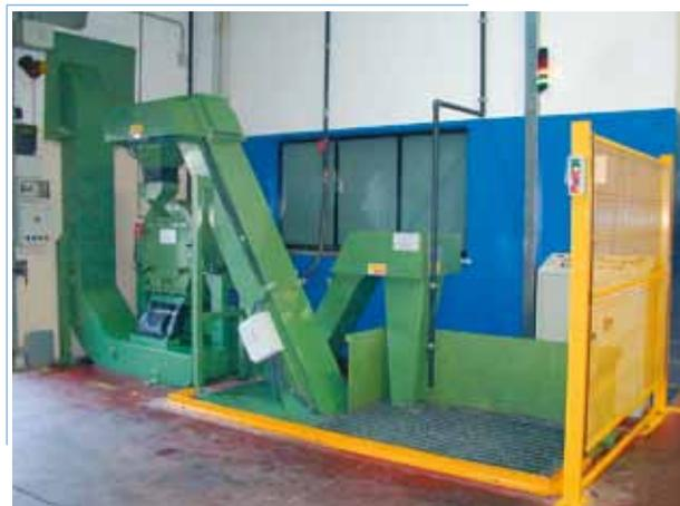
Sistema automático de centrifugado de virutas con evacuación a foso
