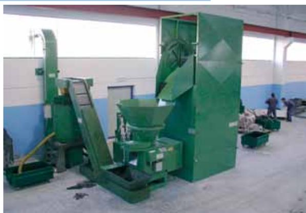
Sistema de triturado y centrifugado de virutas, alimentado por un elevador basculante de carretillas
