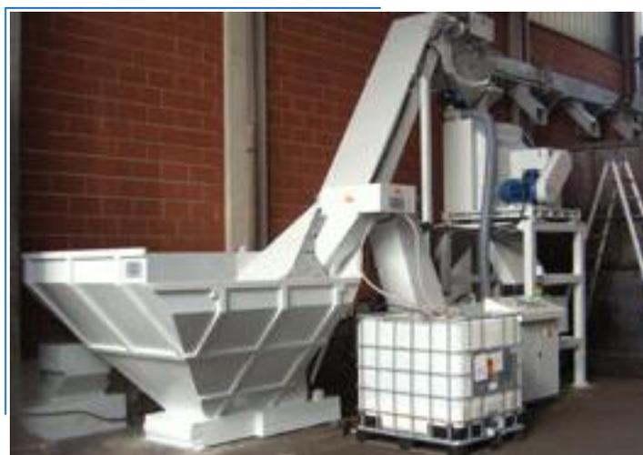
**Sistema di centrifugazione per trucioli di alluminio**
