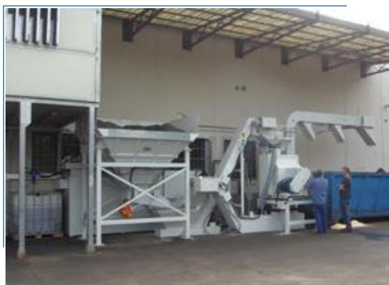
**Impianto di centrifugazione e containerizzazione**
