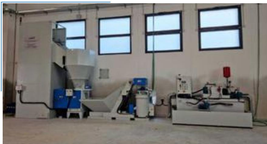
Elevatore + trituratore + Minisystem® + sistema di filtrazione
