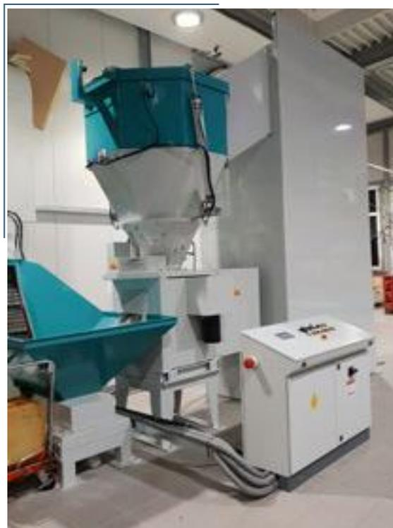
Trituratore modello SCR20, alimentato da elevatore ribaltatore
