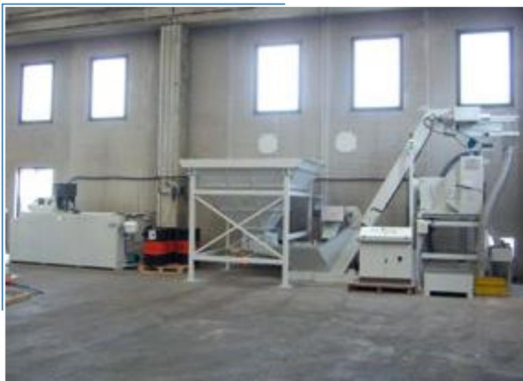
**Sistema di centrifugazione con tramoggia di prestoccaggio di 6m<sup>3</sup>**
