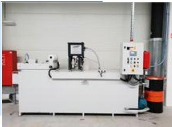
**Sistema centralizzato di filtrazione per emulsioni dotato di filtro a carta, disoleatore e sistema di dosaggio e rilancio**
