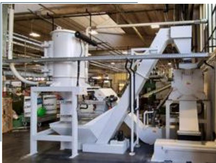
Ciclone con scarico in impianto di centrifugazione e trasporto pneumatico trucioli
