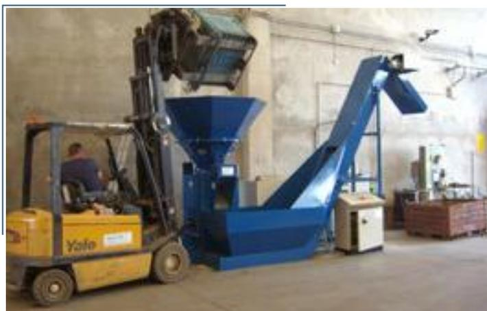
Sistema di triturazione con separatore magnetico
