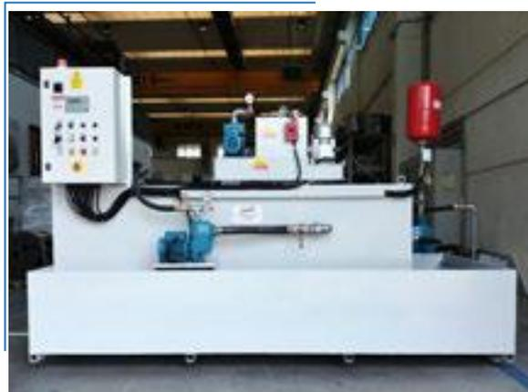
**Sistema di filtrazione olio con rilancio automatico alle macchine utensili**
