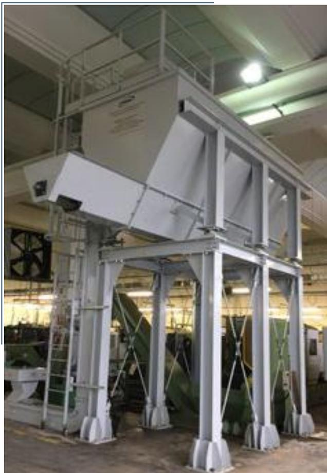
**Silos orizzontale dotato di celle di carico**
