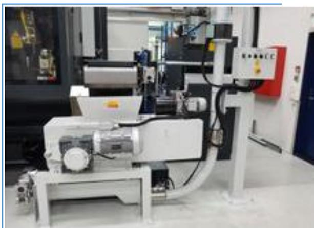
Stazione di aspirazione dotata di tritatore per trucioli di acciaio
