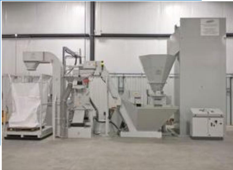
Impianto di triturazione e centrifugazione
