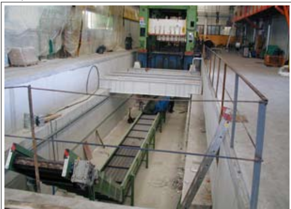
trasporto di trucioli settore automotive
