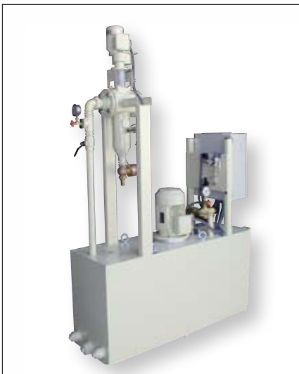
vasca addizionale dotata di pompa ad alta pressione munita di filtro autopulente
