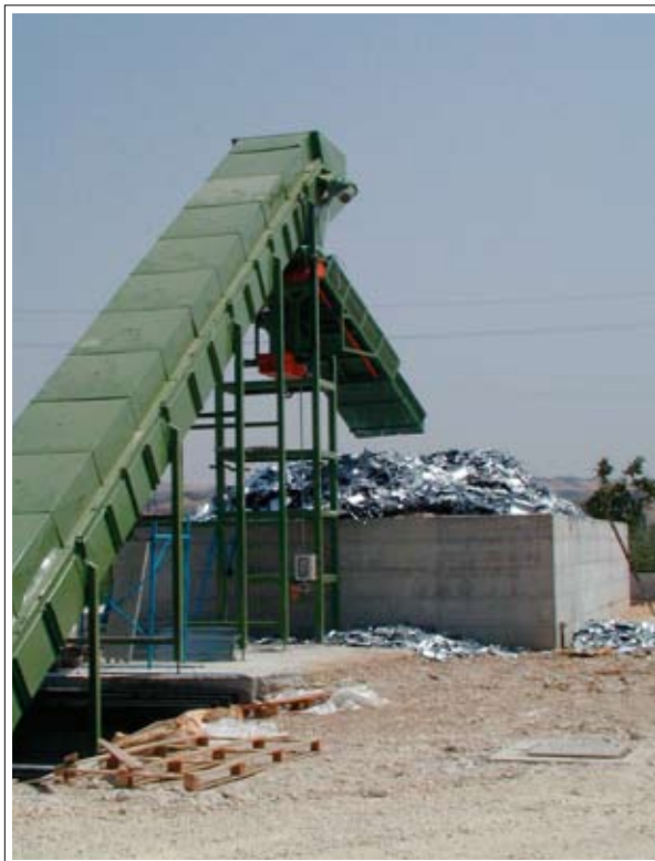
trasportatore terminale di una linea per il trasporto di sfridi metallici
