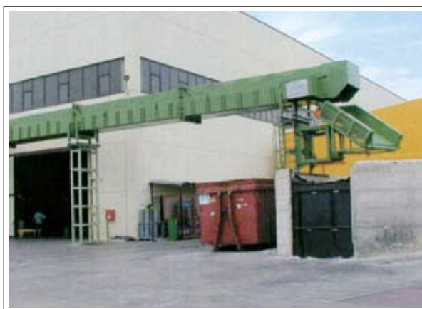
linea per il trasporto di sfridi metallici
