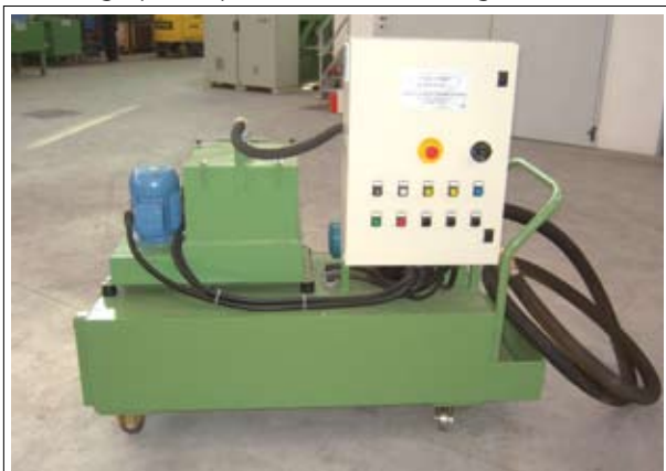
centrifuga per depurazione dell'olio - grado di filtrazione 3-5 micron - portata 50 lt/min
