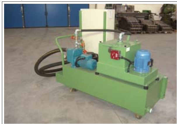
centrifuga per depurazione dell'olio - grado di filtrazione 3-5 micron - portata 50 lt/min
