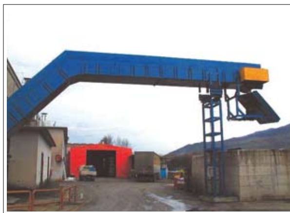
testata di scarico degli sfridi munita di scivolo girevole
